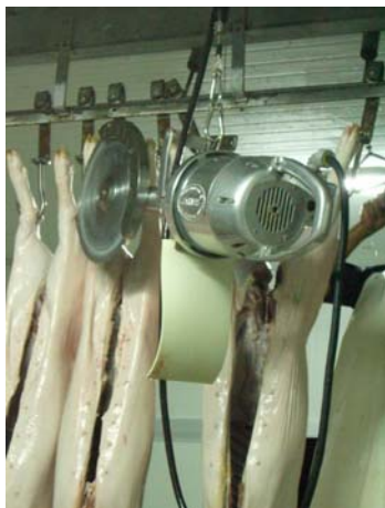
ภาพที่ 39 ผ่าซีกด้วยเลื่อยไฟฟ้า
