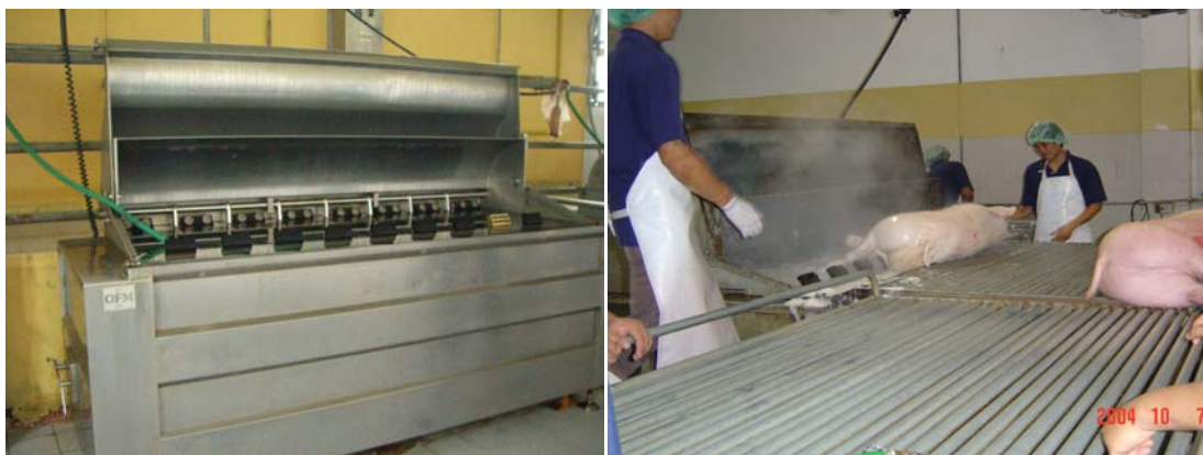
ภาพที่ 35 เครื่องลวกซากและชุดขน (Combined)
