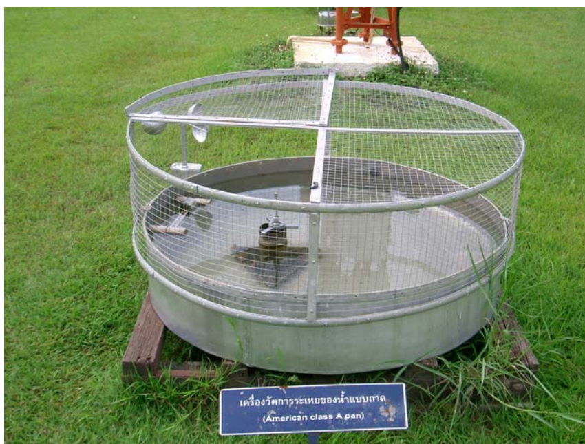
ภาพที่ 9.1 แสดงการวัดการระเหยของน้ำด้วยถาดวัดการระเหย
